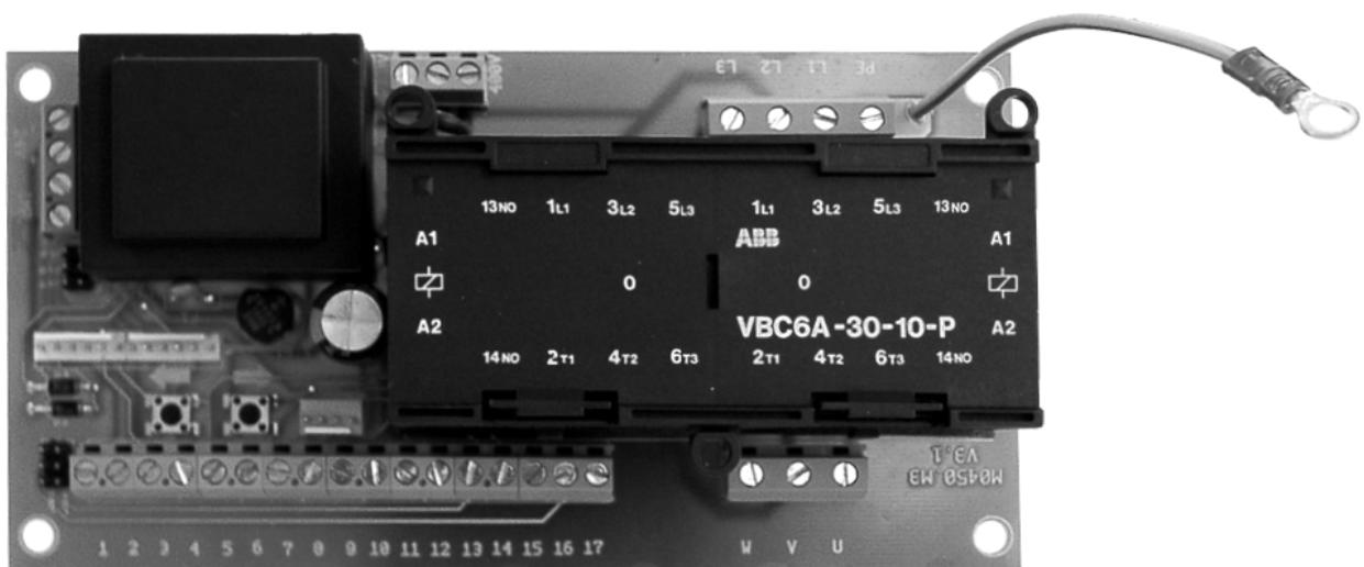
**Die Steuerung AS 210 ist für den Betrieb von Toranlagen konzipiert.
